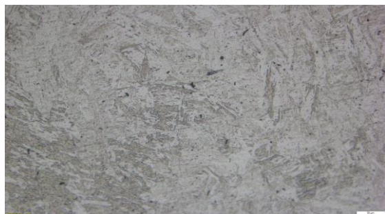
Gambar 5. Strukturmikro Logam Lasan (Weld Metal) dengan Aktif Flux TiO 2
