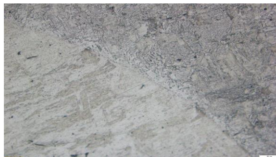
Gambar 4. Struktur mikro HAZ Carbon Steel dengan Aktif Flux TiO 2
