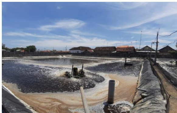
Gambar 1. Kondisi Paddle Wheel Aerator yang Berlumut Pada Mitra Tambak Udang
