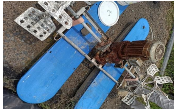
Gambar 2. Motor Listrik Paddle Wheel Aerator yang telah Berkarat dan Rusak
