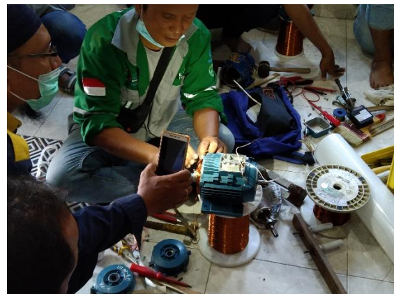
Gambar 7. Proses Menjahit Motor Menggunakan Benang
