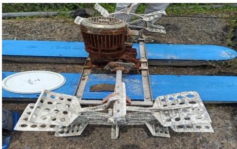
Gambar 2. Kondisi Paddle Wheel yang Rusak
