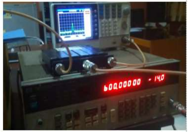
Gambar 2. Foto pengukuran analisis duplexer
