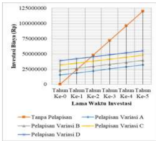
Gambar 4. Grafik Analisis Investasi Biaya Pelapisan Material FRP pada Kayu
