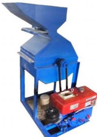
Gambar 2. Alat Hammer mill/penepung
