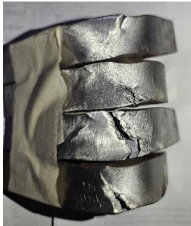
Gambar 6 Hasil Pengamatan Uji Tekuk BFA
