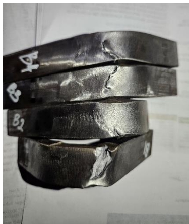
Gambar 7 Hasil Pengamatan Uji Tekuk BFB
