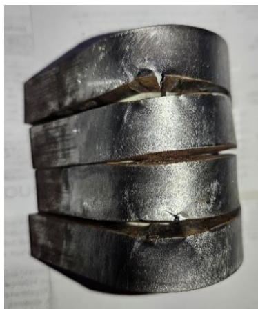
Gambar 4 Hasil Pengamatan Uji Tekuk 80B
