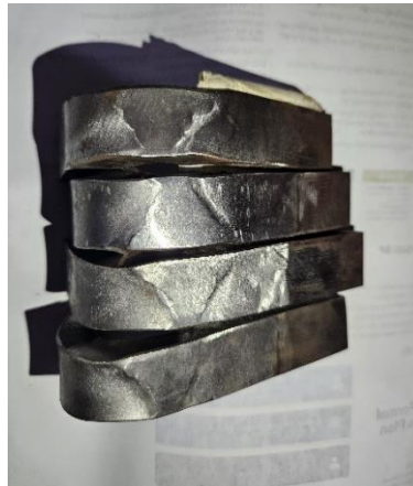
Gambar 8 Hasil Pengamatan Uji Tekuk BFC
