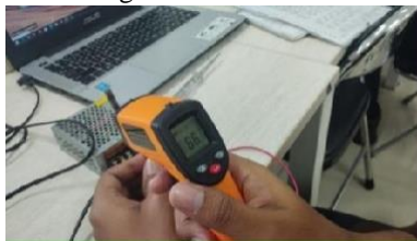
Gambar 25 Kondisi 1 Heater Cardridge 24VDC Sesudah diberi Tegangan
