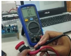
Gambar 23 Kondisi saat push button ditekan (NO)
