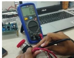
Gambar 22 Kondisi saat push button tidak ditekan (NC)
