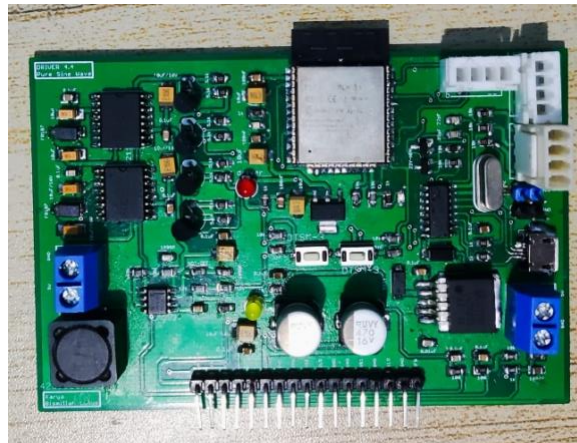
Gambar 7. Hasil PCB Driver MOSFET Sesudah Dipasangkan Komponen
