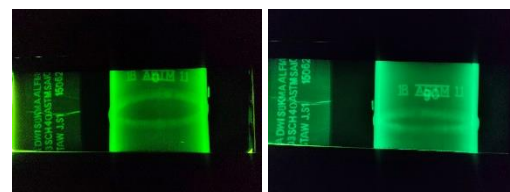
Gambar 6. Hasil uji radiografi pada material dengan variasi flowrate shielding gas 15 L/min
