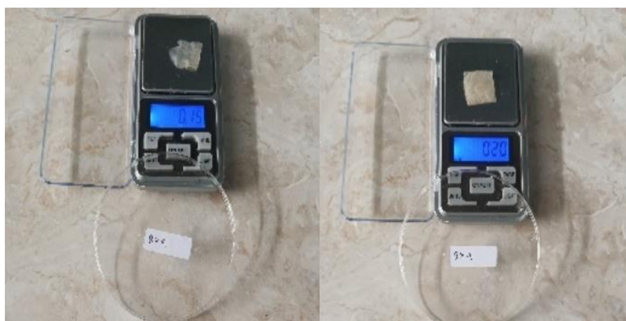
(a) Bioplastik sebelum perendaman (b) Bioplastik setelah perendaman
