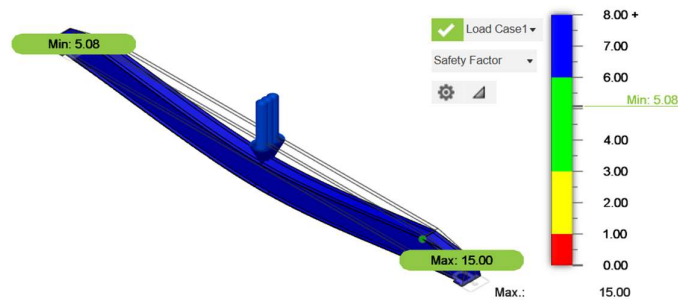
Gambar 10. Analisis Safety Factor Pada Girder
