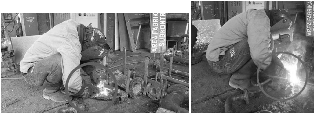
Gambar 5. Postur Janggal Pada Pengelasan Pipa
