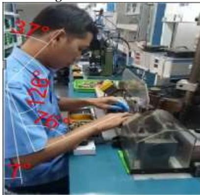
Gambar 3. 1 Postur Tubuh Pekerja Saat Memasang Besi ke Mesin
