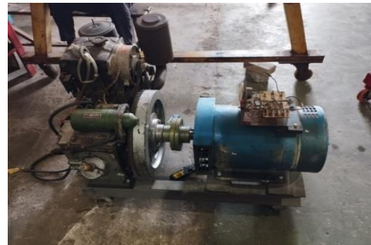
Gambar 2 Jiangdong Four-Stroke Diesel Engine dikapal dengan generator
