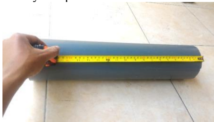
Gambar 3. Pengukuran Pipa PVC
