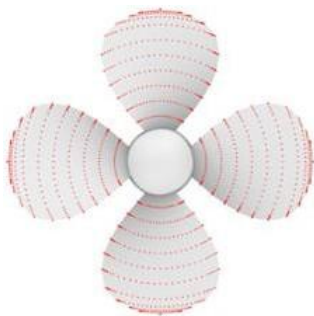
Gambar 5. Desain propeller 4 blade pada Rhino
