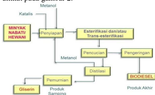
Gambar 2 Skema Produksi Biodiesel
