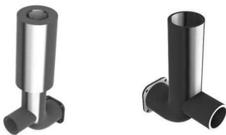
Gambar 2.3 (a) Exhaust Manifold dan (b) Intake Manifold yang dimodifikasi
