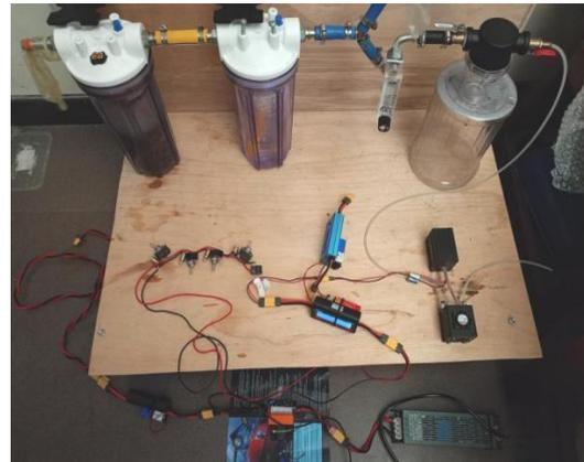
Gambar 3.2 Skema Prototype Hidrogen Generator untuk *Proton Exchange Membrane Fuel Cell* (PEMFC)
