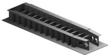
Gambar 2 Pemodelan 3D Pondasi Mesin Induk
