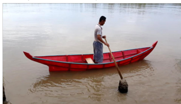
Gambar 11. Proses pengujian perahu fiberglass
