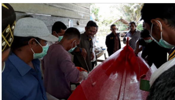
Gambar 8. Pemasangan fiberglass dan pemolesan resin pada cetakan
