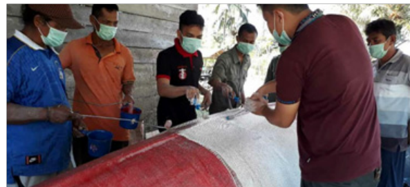
Gambar 4. Pembuatan mal perahu fiber
