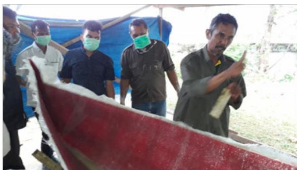
Gambar 9. Proses pengeringan resin perahu fiberglass dalam cetakan
