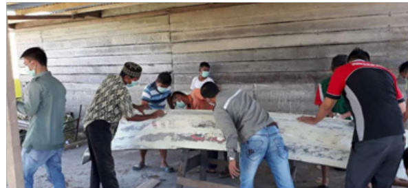
Gambar 3. Proses penghalusan permukaan perahu
