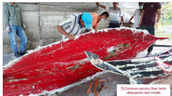
Gambar 6. Proses pelepasan mal dari model
