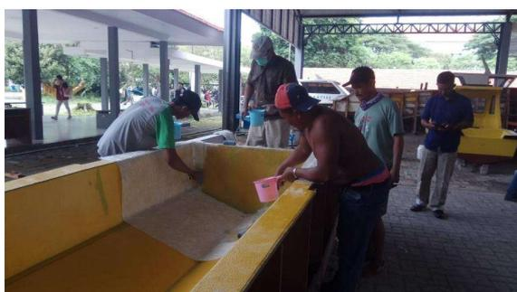
Gambar 5. Pemasangan Matt pada Cetakan
