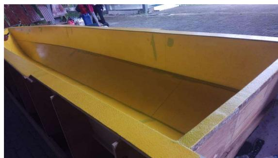
**Gambar 4. Hasil pelapisan Lambung kapal dengan Gelcoat.**
