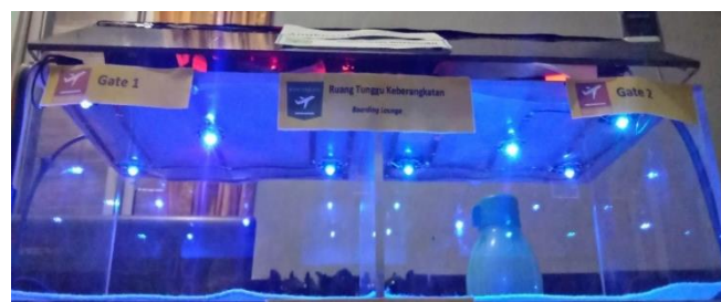
Gambar 7. Pengujian lampu Ruang Tunggu Keberangkatan pada saat penerbangan on
