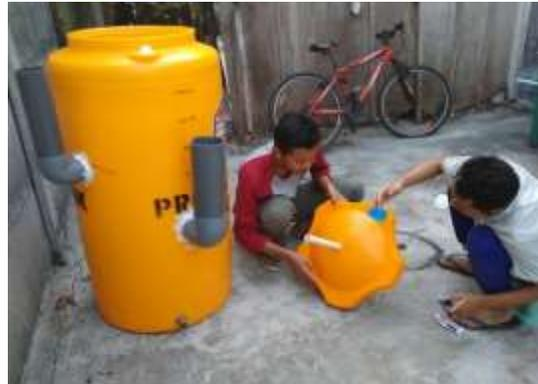
Gambar 12. Proses pemasangan saluran pipa gas
