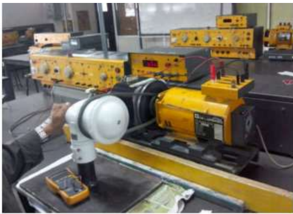
Gambar 7. Pengukuran Tegangan keluaran generator turbin angin
