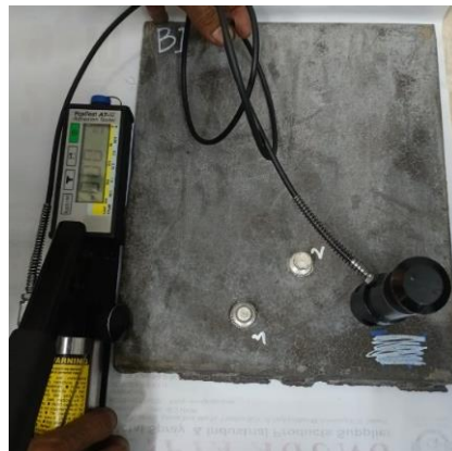
Gambar 4. Pengujian Pull Off Test
