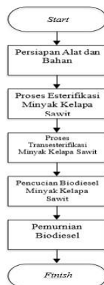
Gambar 3. Diagram Alir Pembuatan Biodiesel Minyak Kelapa Sawit
