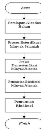
Gambar 4. Diagram Alir Pembuatan Biodiesel Minyak Jelantah
