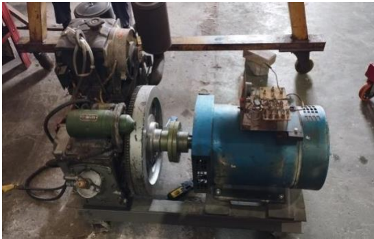
Gambar 1. ZH1115N Diesel Engine Jiandong dikopel dengan generator
