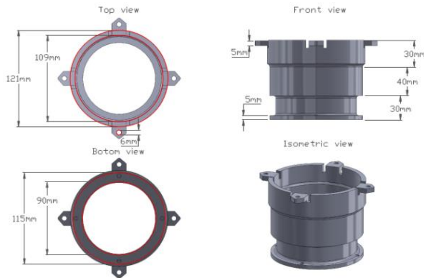
Gambar 3. Gambar teknik pondasi tambahan konversi motor listrik
