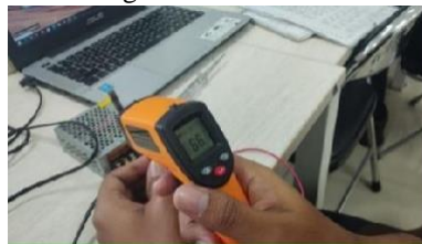
Gambar 25 Kondisi 1 Heater Cardridge 24VDC Sesudah diberi Tegangan
