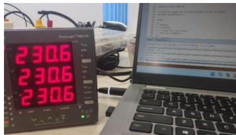
Gambar 12 Hasil Pengujian Nilai Tegangan PM2100
