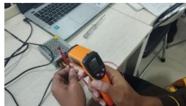
Gambar 26 Kondisi 2 Heater Cardridge Sesudah diberi tegangan
