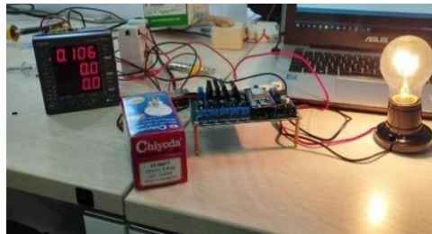
Gambar 13 Hasil Pengujian Arus PM2100
