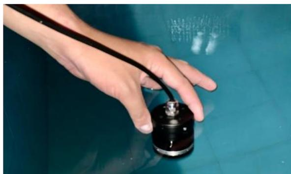
**Gambar 4.** Proses Pengukuran Kedalaman Perairan menggunakan Sensor
