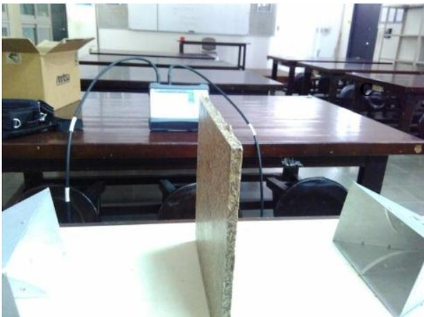
Gambar 7. Pengukuran Reflection loss dan Return Loss
