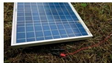
Gambar 4. Instalasi pada Output Solar Cell
