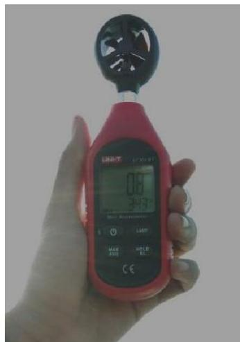
Gambar 1. Pengukuran kecepatan angina saat pengujian
