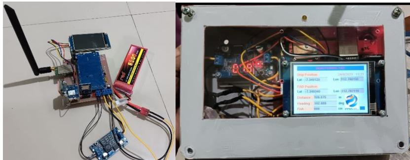
Gambar 8. Perangkat Sistem Komunikasi Data pada Kapal
