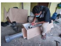
Gambar 1. Proses fabrikasi kolektor surya
