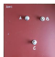
Gambar 5. Pemasangan dolly pada permukaan substrat Aluminium H116
