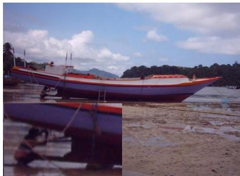
Gambar 1 Kapal Nelayan tradisional Sendang Biru jenis sekoci dengan pemasangan poros propeller membentuk sudut (*angel*)
