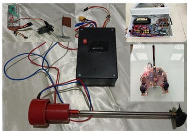
Gambar 8 Unit penggerak kontrol otomatis
