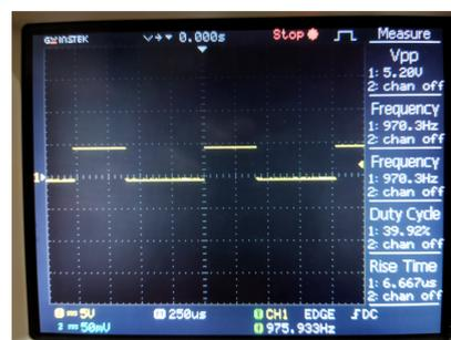
Gambar 9 Pengukuran Sinyal PWM saat Data 100
