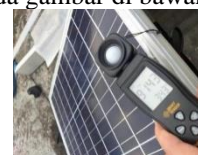
Gambar 4.2 Menguji Intensitas Sinar Matahari dengan Lux meter
