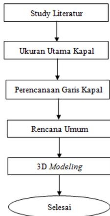
Gambar 2. Diagram Alir Perancangan Kapal
