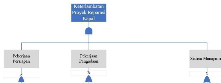
Gambar 2 TOP FTA Proyek Reparasi Kapal SPOB Messi Kianna 1 yang mengalami keterlambatan
