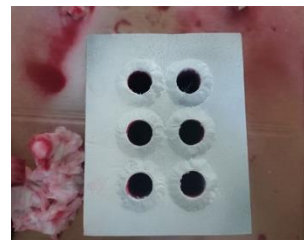
Gambar 4 Hasil Pengujian Liquid Dye Penetrant
