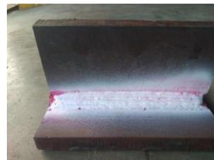
Gambar 4. Hasil pengujian penetran 120A/150°C
