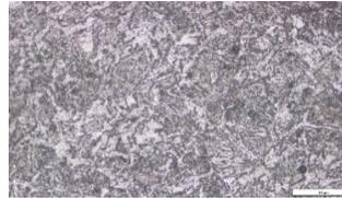
Gambar 22. Hasil pengujian mikro 150A/150°C HAZ
