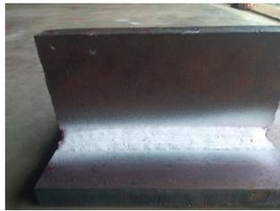
Gambar 7. Hasil pengujian penetran 150A/150°C
