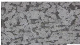
Gambar 9. Hasil pengujian mikro 120A/75°C BM
