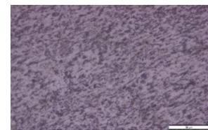
Gambar 24. Hasil pengujian mikro 150A/75°C WM
