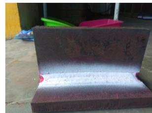
Gambar 5. Hasil pengujian penetran 150A
