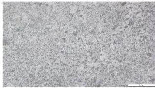
Gambar 16. Hasil pengujian mikro 120A/150°C WM
