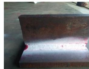
Gambar 3. Hasil pengujian penetran 120A/75°C
