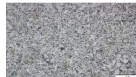
Gambar 25. Hasil pengujian mikro 150A/150°C WM
