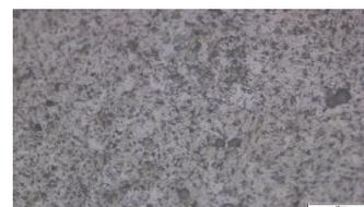
Gambar 15. Hasil pengujian mikro 120A/75°C WM
