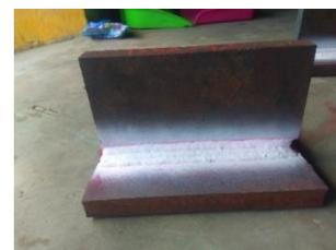
Gambar 6. Hasil pengujian penetran 150A/75°C
