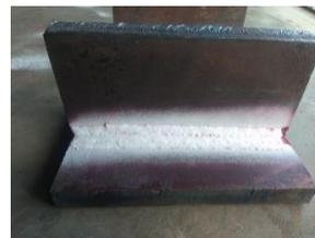
Gambar 2. Hasil pengujian penetran 120A
