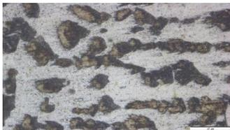
Gambar 19. Hasil pengujian mikro 150A/150°C BM
