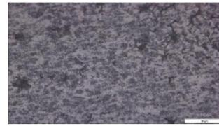
Gambar 21. Hasil pengujian mikro 150A/75°C HAZ
