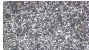
Gambar 11. Hasil pengujian mikro 120A HAZ
