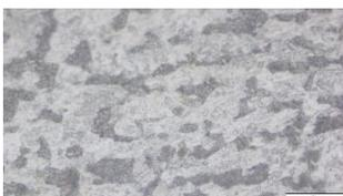
Gambar 10. Hasil pengujian mikro 120A/150°C BM
