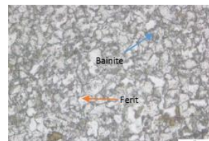
Gambar 1. Hasil pengujian mikro pada variasi interpass temperature 100 °C
