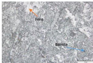
Gambar 7. Hasil pengujian mikro pada variasi interpass temperature 400 °C
