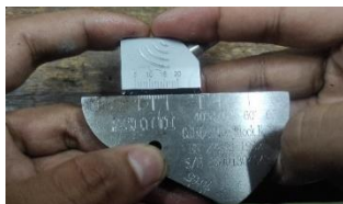
Gambar 3.3 Kalibrasi Jarak Menggunakan Blok V2
