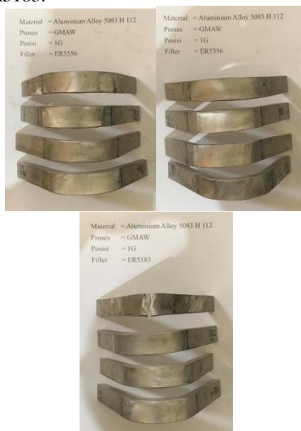
Gambar 3.1 Hasil Uji Bending Filler ER 5556, ER5 183, ER5356
