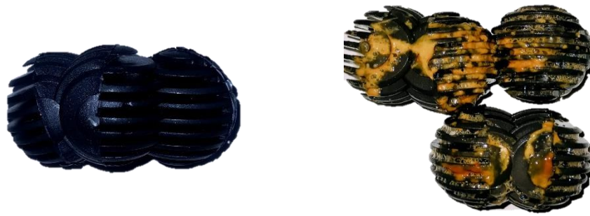
(a) Media Bioball Sebelum Seeding (b) Media Bioball Setelah Seeding
