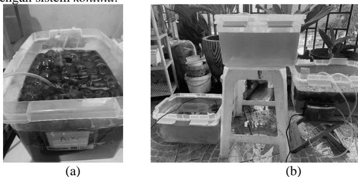
**Gambar 1**(a) Reaktor *Seeding* Sistem *Batch* dan (b) Reaktor *Seeding* Sistem *Batch-Kontinu*
