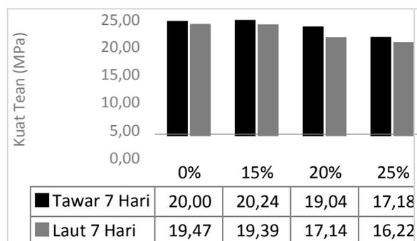
Gambar 1. Kuat Tekan Terhadap Substitusi Copper Slag
